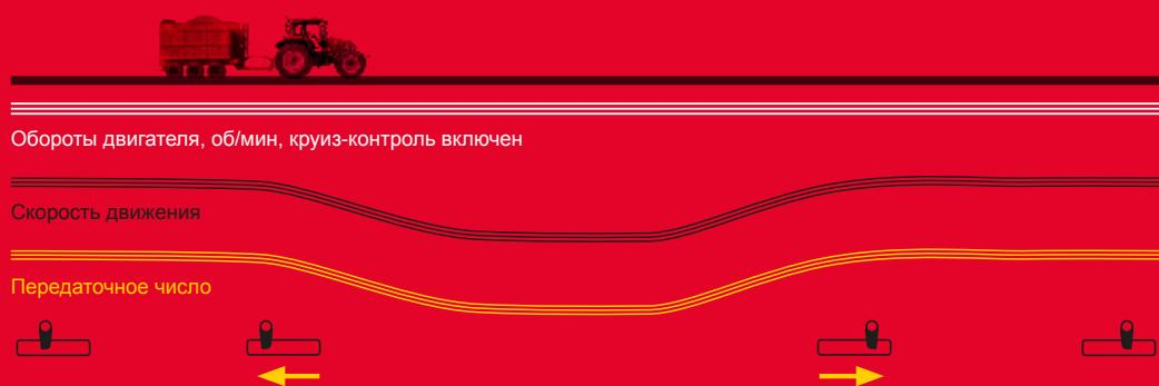
Ручной режим можно выбирать в рабочих областях А и В. Передаточным числом трансмиссии управляет только оператор, используя для этого рычаг CVT. Особенно удобен при уборке урожая, когда требуется определенная скорость движения для различных условий и культур.
