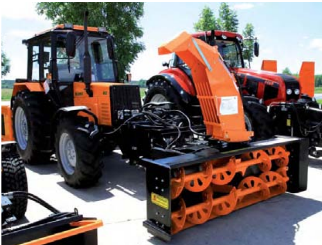
Фотография: Роторный снегоочиститель PRONAR OW 2.4H (с приводом от гидравлического двигателя ZHD170)
