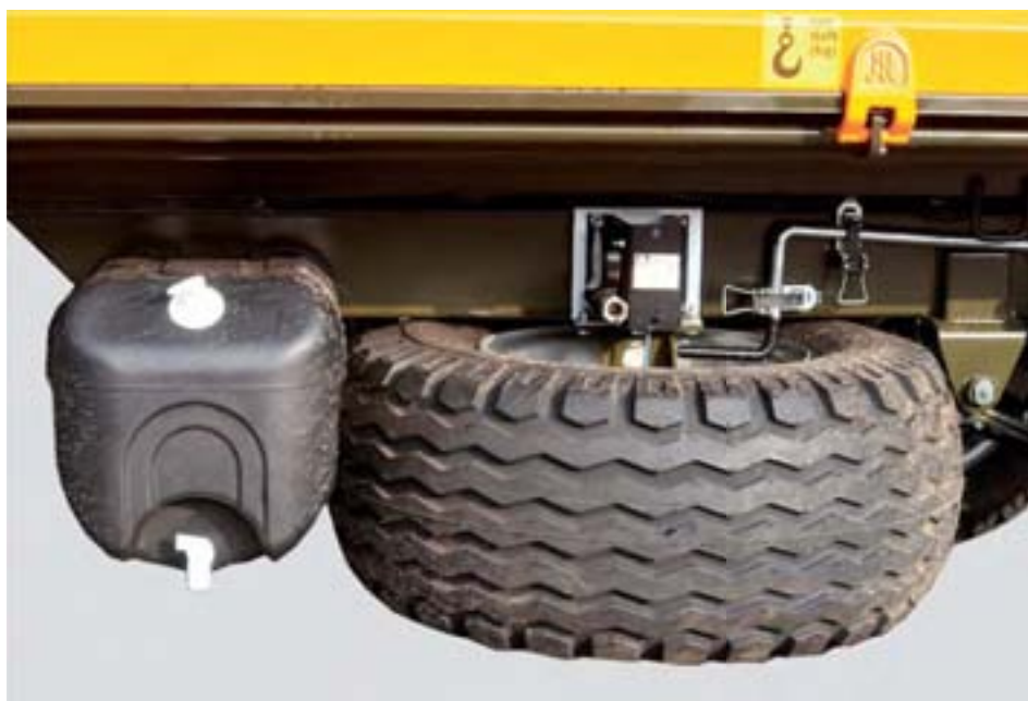
Фотография: Дополнительное оснащение прицепа РТ606: запасное колесо с лебёдкой прикрепленное к раме шасси. Рядом с ёмкостью для воды и мылом.
