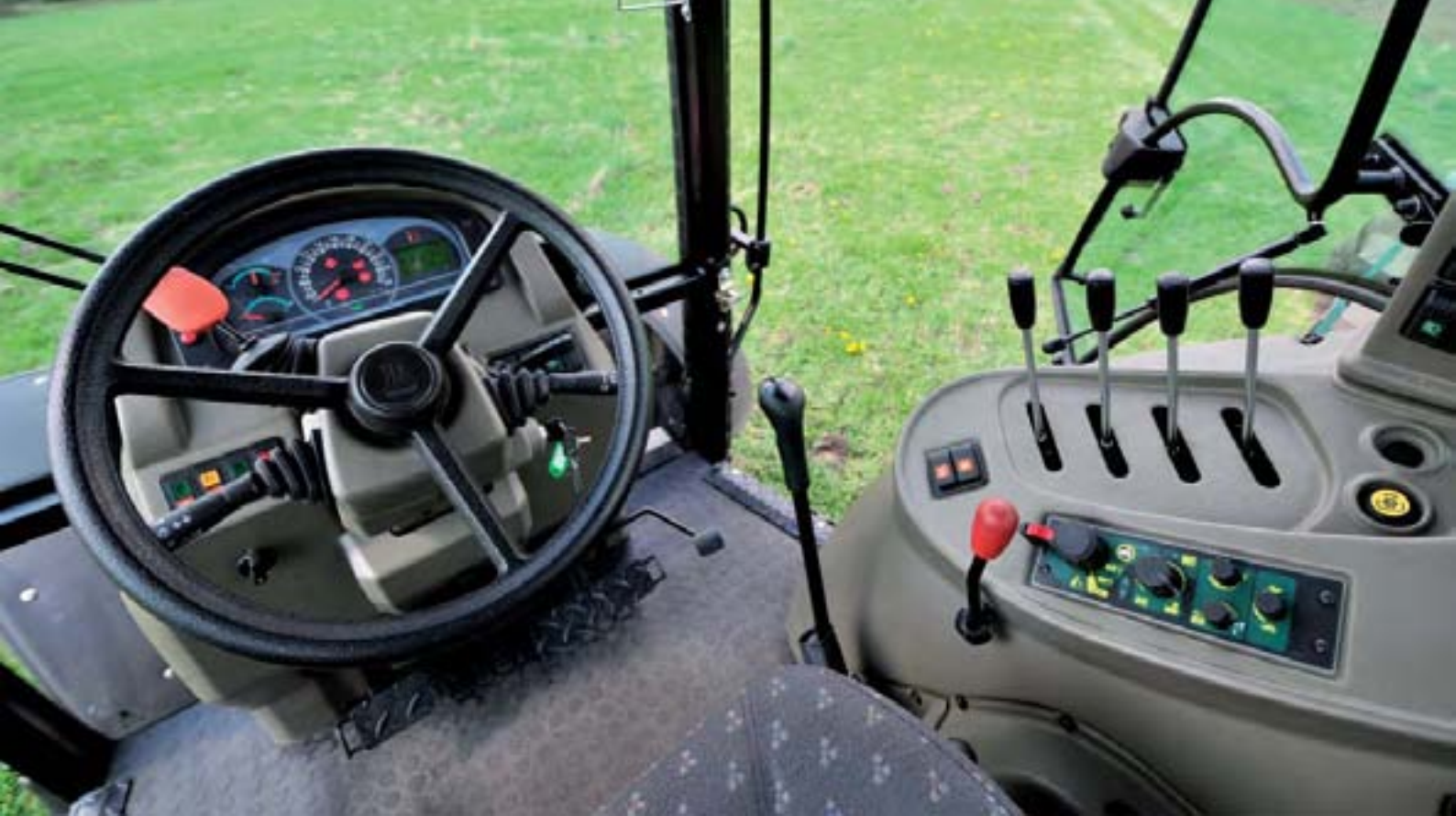
Фотография: Изменение направления езды возможна с помощью переключателей под рулём (оранжевый рычаг с левой стороны). Место глушителя с правой стороны от столбика улучшает видимость
