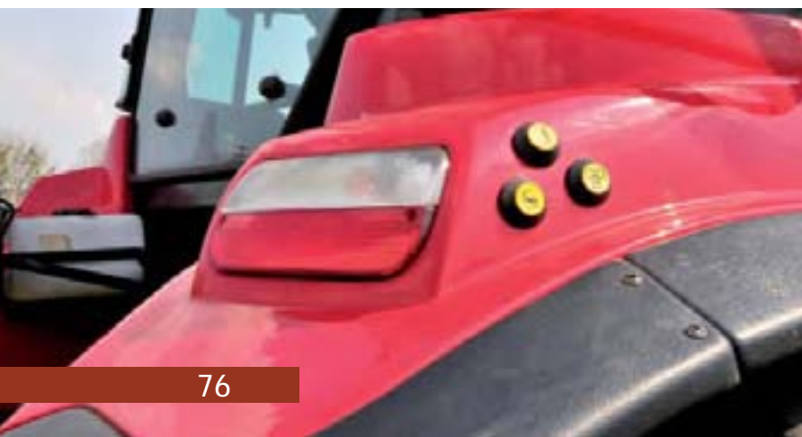
Фотография: Внешние кнопки управления ТСН и ВОМом, облегчающие агрегирования машин
