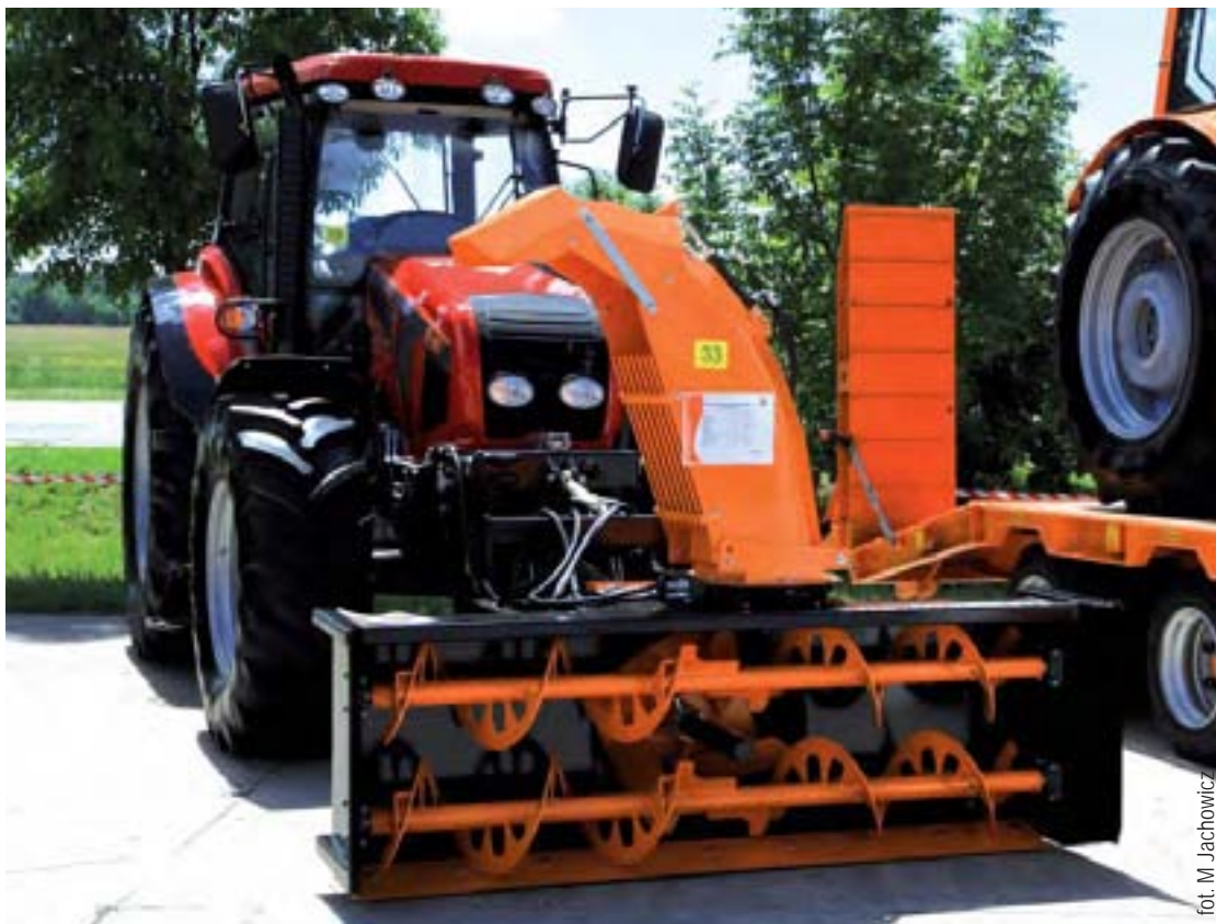
Фотография: Роторный снегоочиститель PRONAR OW 2.4M
