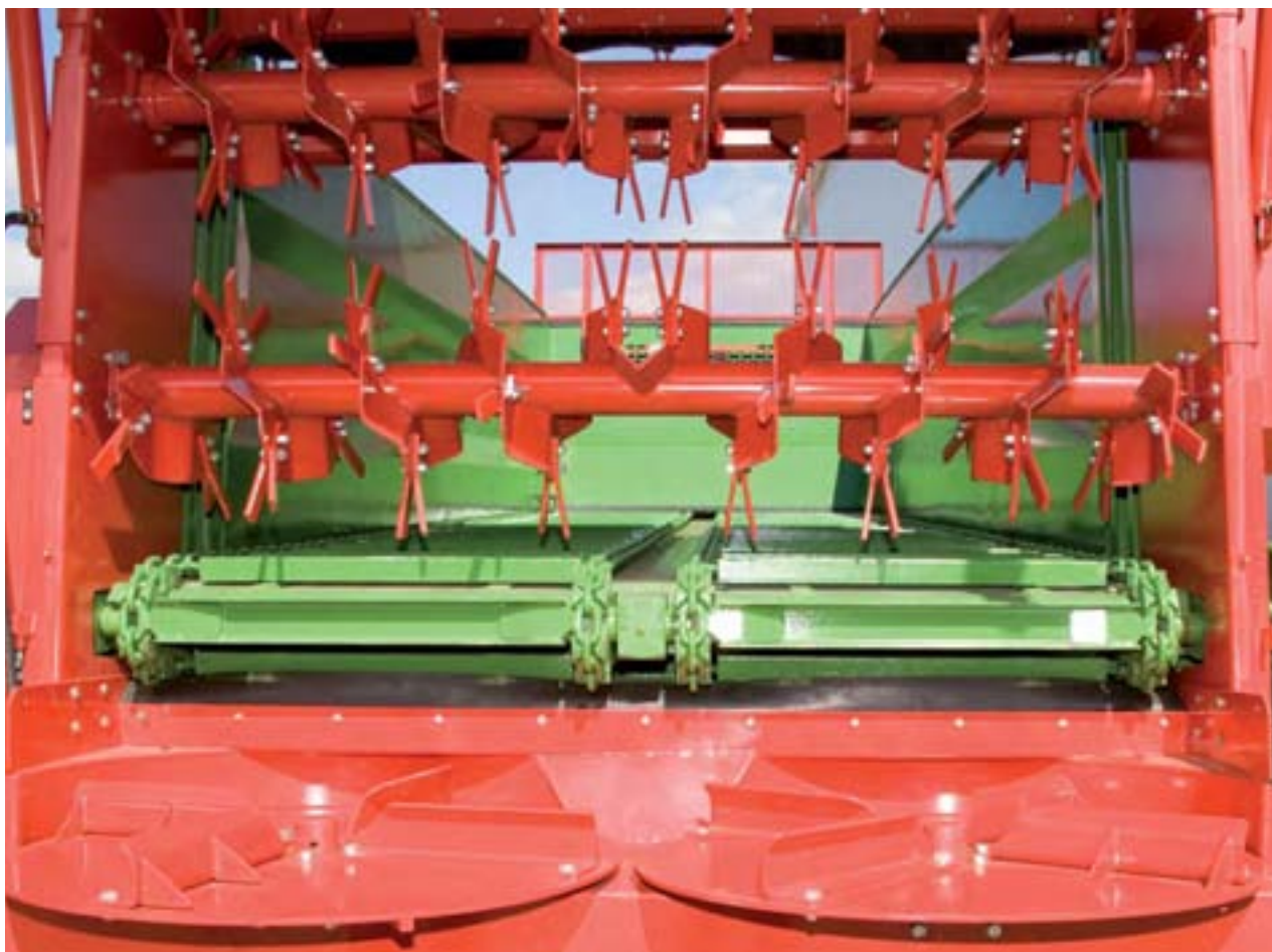
Фотография: Нижний двухвалковый измельчающий адаптер и два диска механизма широкого разброса разбрасывателя N262
