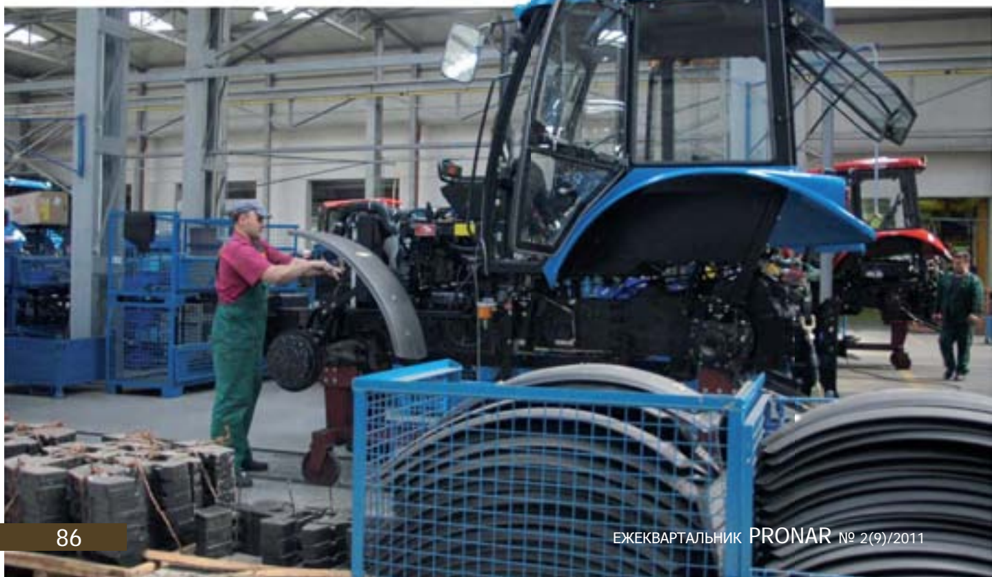
Фотография: Монтаж деталей из пластмассы
