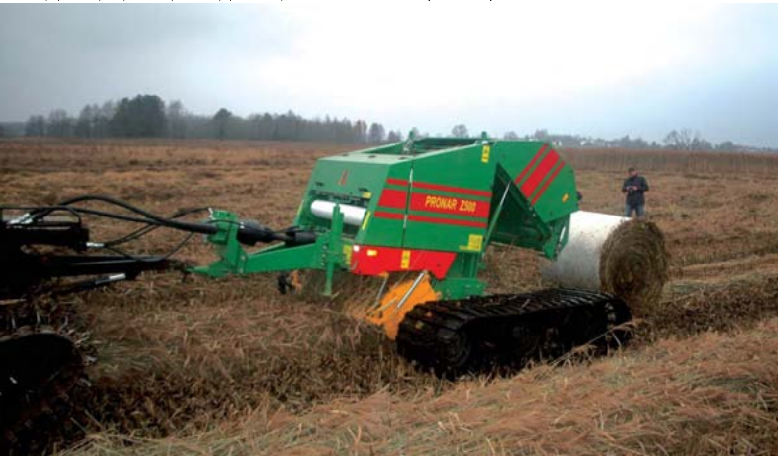
Фотография: Модернизированный пресс-подборщик Z500 с торговым наименованием Z500G на гусеничном ходу
