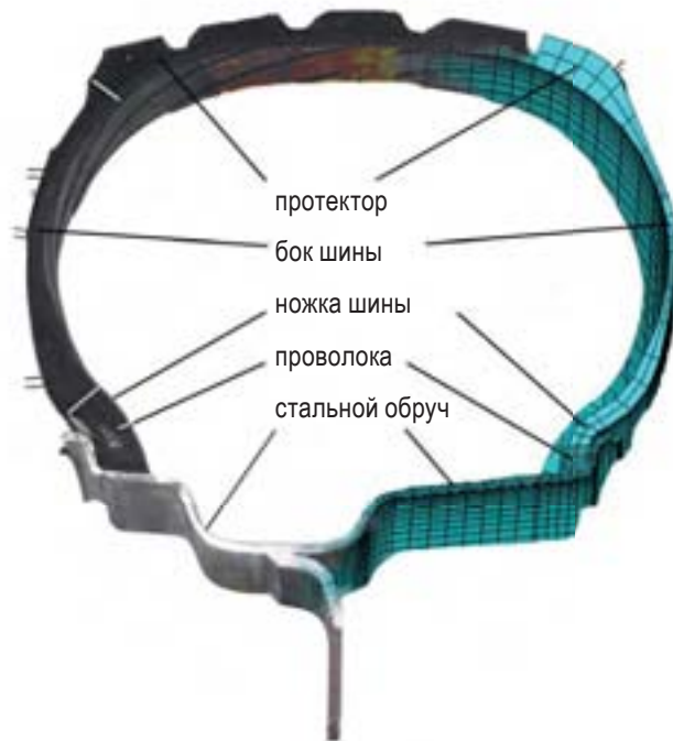
Фотография: Поперечное сечение дискового колеса с шиной. Реальное изображение (модель МКЭ): протектор, боковина шины, борта шины, бортовая проволока, стальной корд
