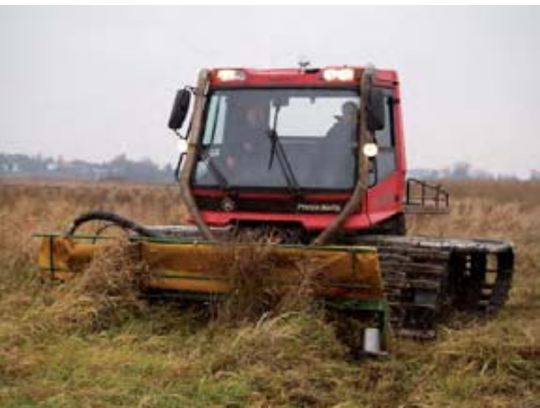
Фотография: Дисковая косилка фирмы Pronar приспособлена для работы с ратраком
