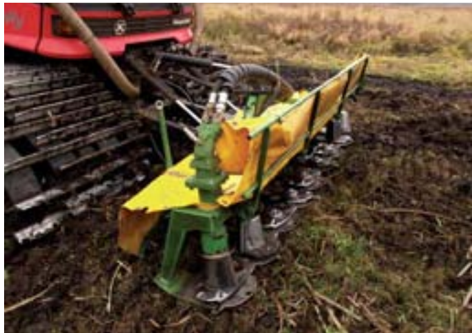
Фотография: Косилка PDF380R работает не от ВОМ, а от очень производительной гидравлической системы. При рабочей ширине 3,8 м и объемом потребления гидравлической системы, равным 115 л/мин, производительность косилки составляет около 4 га/ч. Ширина покоса составляет 1,5-2 м
