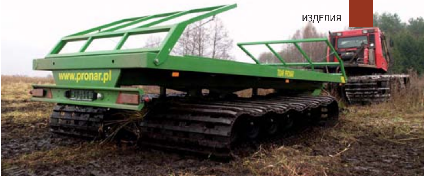
Фотография: Платформа T024R весом 5 тонн въезжает на болотистую территорию и не тонет даже в нагруженном состоянии
