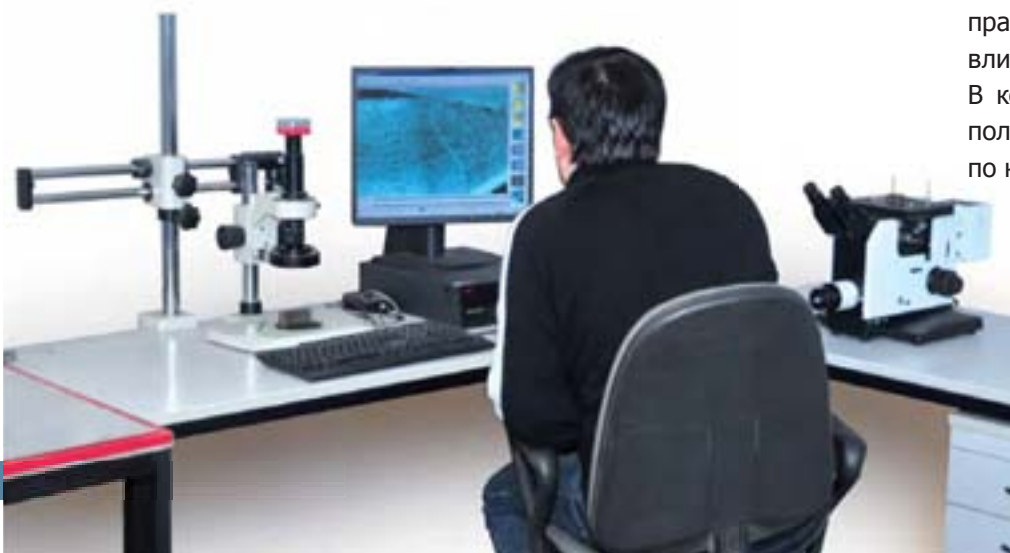
Фотография: Площадка для проведения макро- и микроскопических исследований с комплектом для анализа изображений
