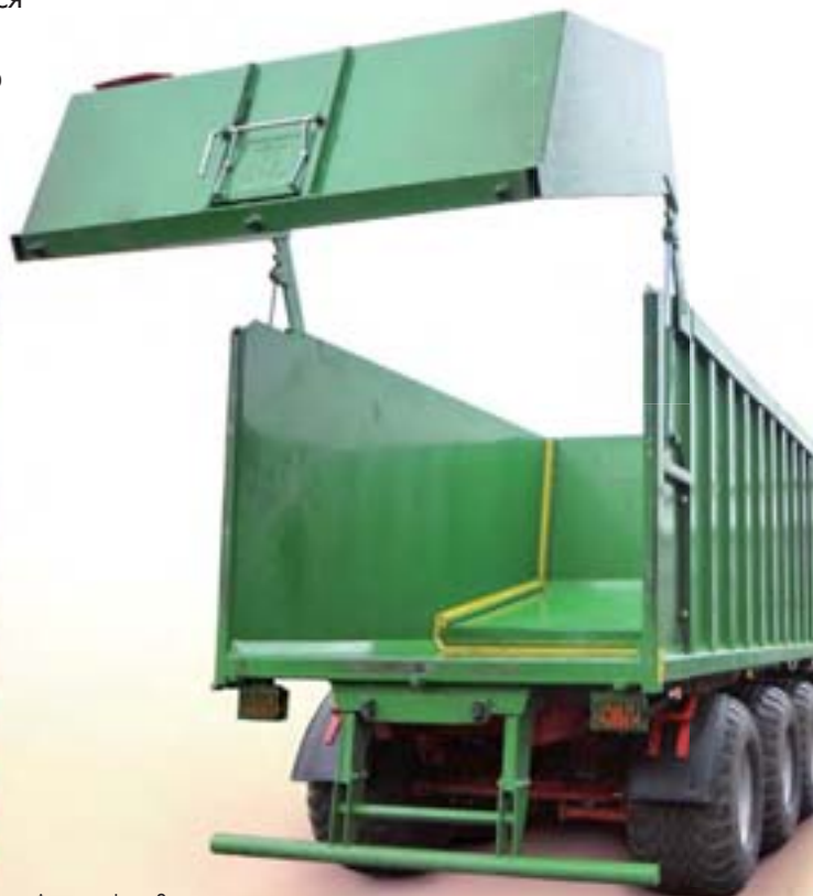
Фотография: Задняя откидная дверь, поднимаемая гидравлически с сыпным люком для зерна
