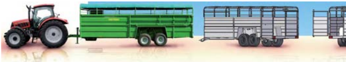
Фотография: Прицеп T046/2 в базовой комплектации оборудован гидравлически опускаемой загрузочной поверхностью для облегчения погрузки животных
