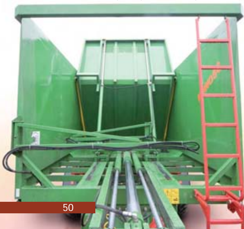
Фотография: Гидравлическая система передвижения и подъема стенки
