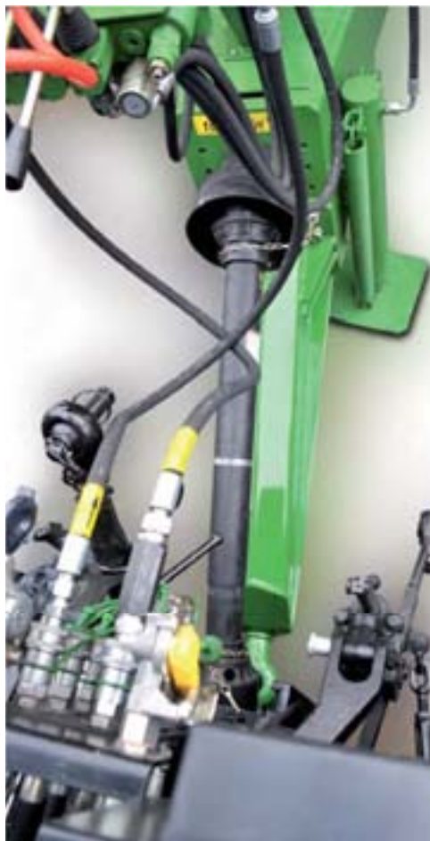
Фотография: Соединение разбрасывателя PRONAR N262 с трактором
