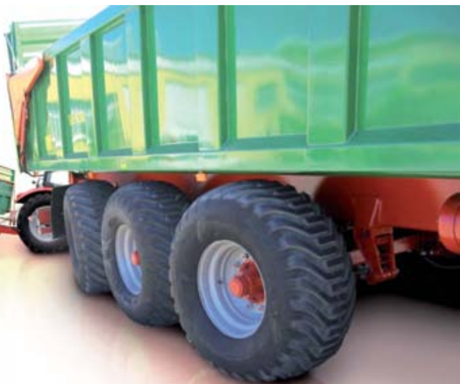
Фотография: Подвижные оси, повышающие поворотливость и маневренные возможности прицепа T682
