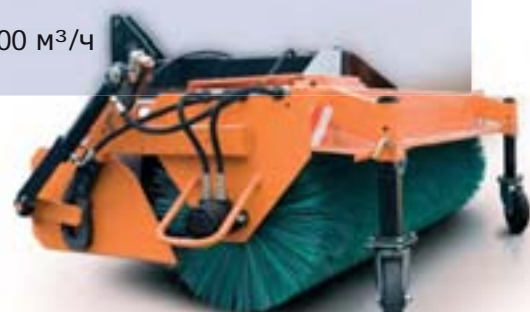
Фотография: Подметально-уборочная машина в стандартной версии монтируется на задней ТСН
