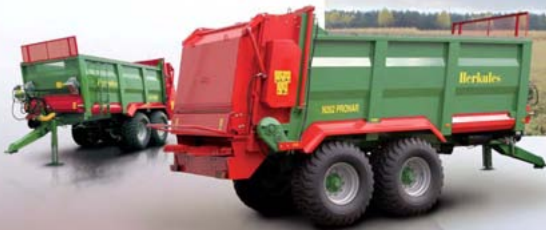
Фотография: Адаптер имеет два горизонтальных барабана с двумя разбрасывающими дисками. Ширина разброса в зависимости от вида материала может достигать до 25 м
