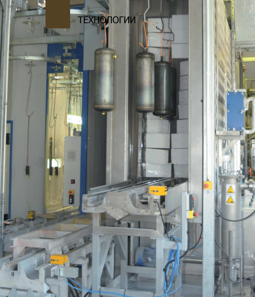
Напорные резервуары пневматических тормозных систем в процессе начала процесса мытья в сквозной мойке
