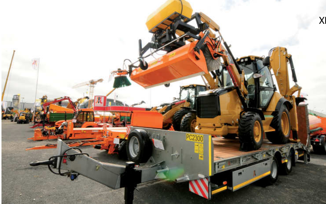
Подметальная машина Agata ZM-2000, агрегированная с экскаватором-погрузчиком Caterpillar CAT432E
