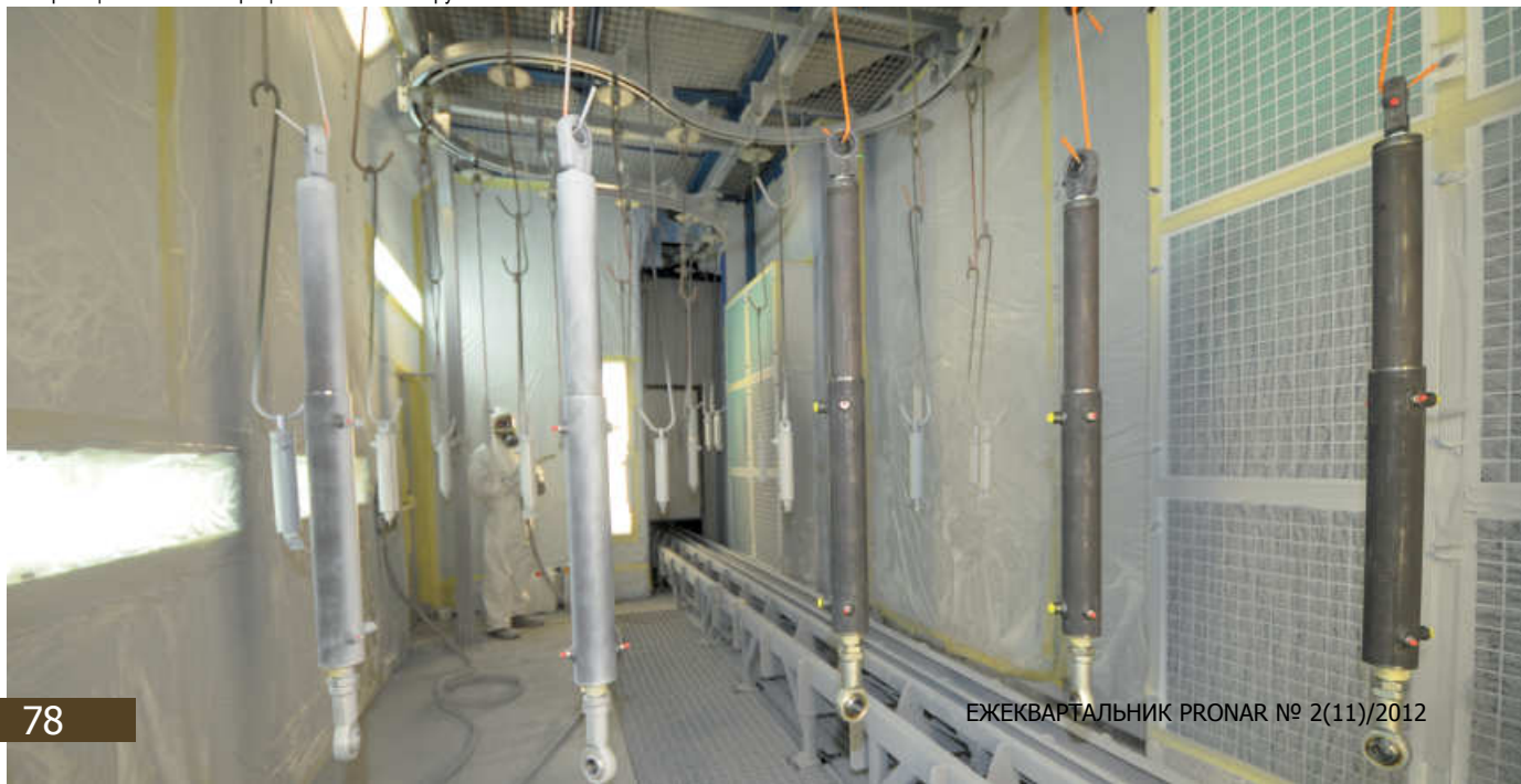
Лакировщик в кабине в процессе нанесения грунтовки
