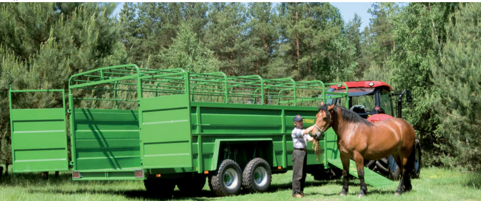
Прицеп PRONAR T046/2 с двойной осью и подвеской типа „тандем“ с внутренней длиной 7 м
