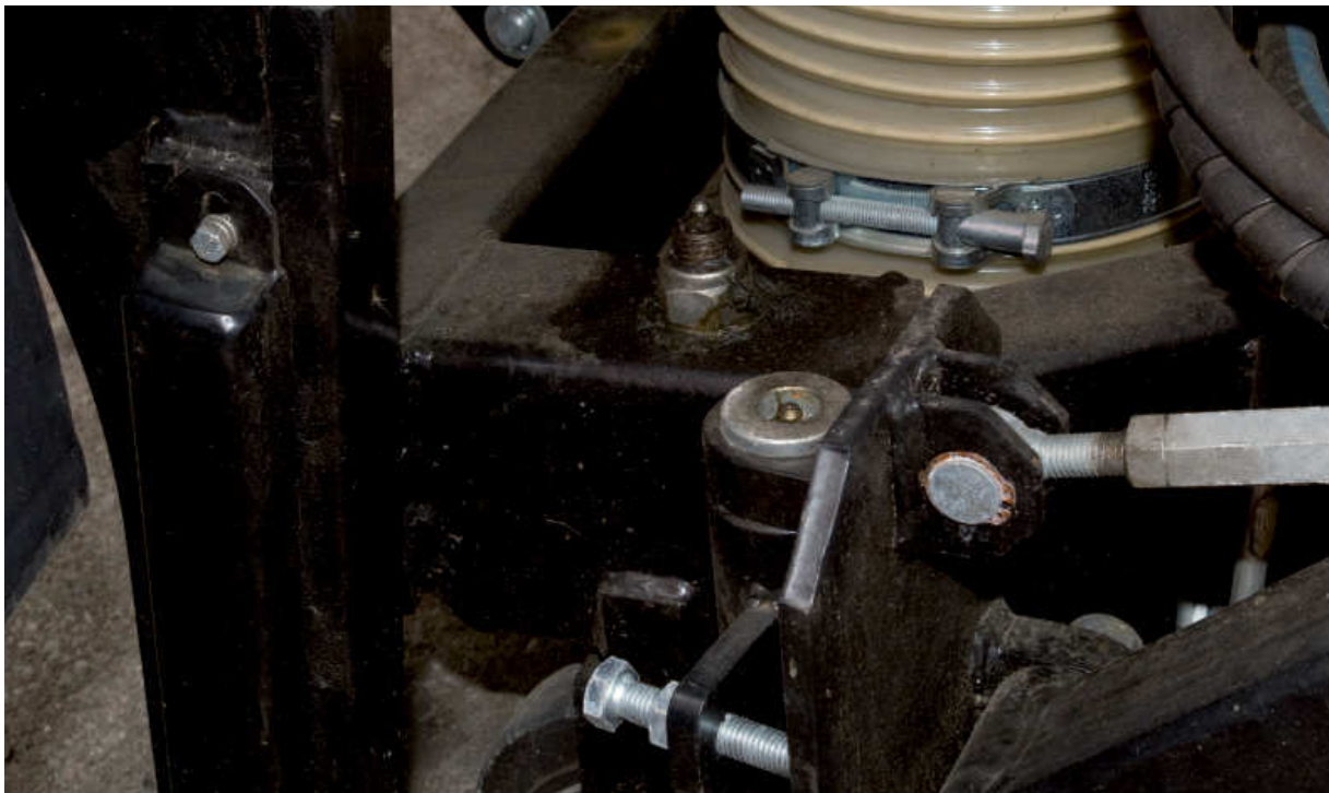
Все точки смазки должны быть смазаны в соответствии с указаниями в руководстве по обслуживанию
