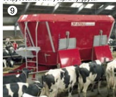
9 Модельный ряд кормосмесителей – раздатчиков от JF-STOLL со шнеками, которые обеспечивают как вертикальное, так и горизонтальное смешивание корма объемом от 6,5 до 45 м 3
