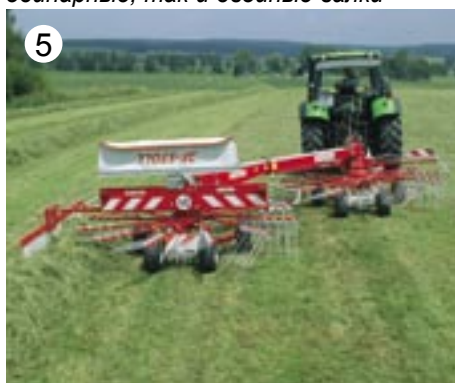
5 JF-STOLL производит валкообразователи с шириной захвата от 2,9 до 8,6 м
