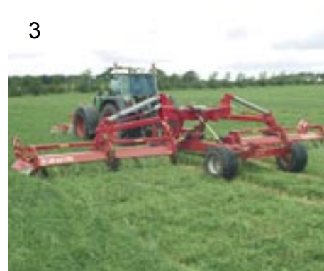
3 JF-STOLL выпустил первую прицепную комбинацию из 3-х косилок с шириной захвата 12м.
